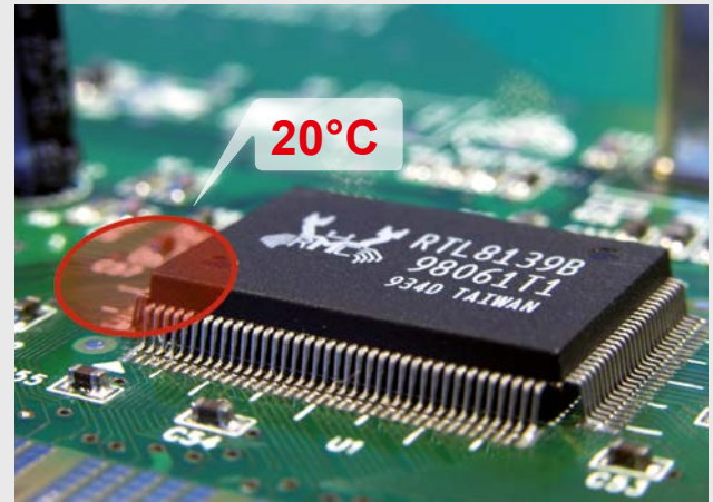
Çok büyük olarak seçilmiş ölçüm noktası ve bunun sonucunda meydana gelen ölçüm hatası
