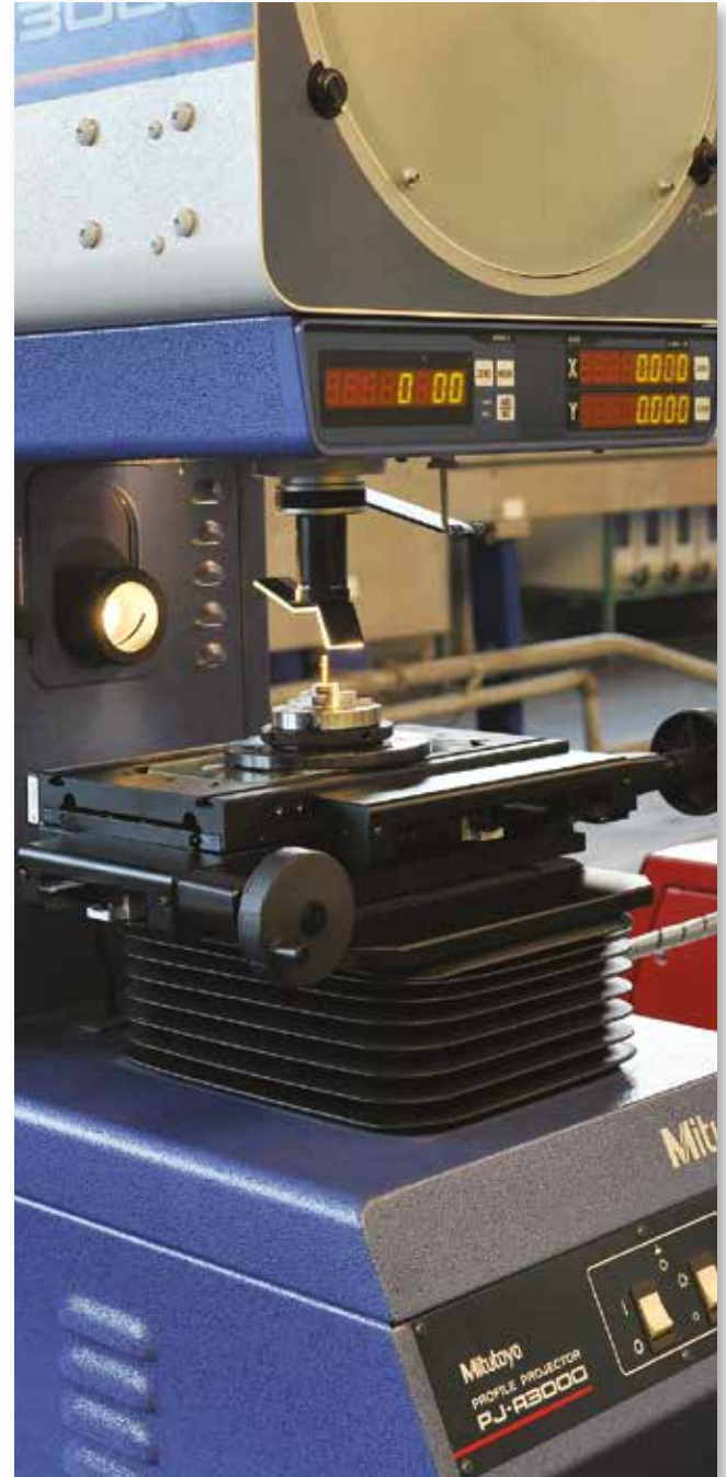
Profil projektör ile geometrik ölçümler yapılır.
