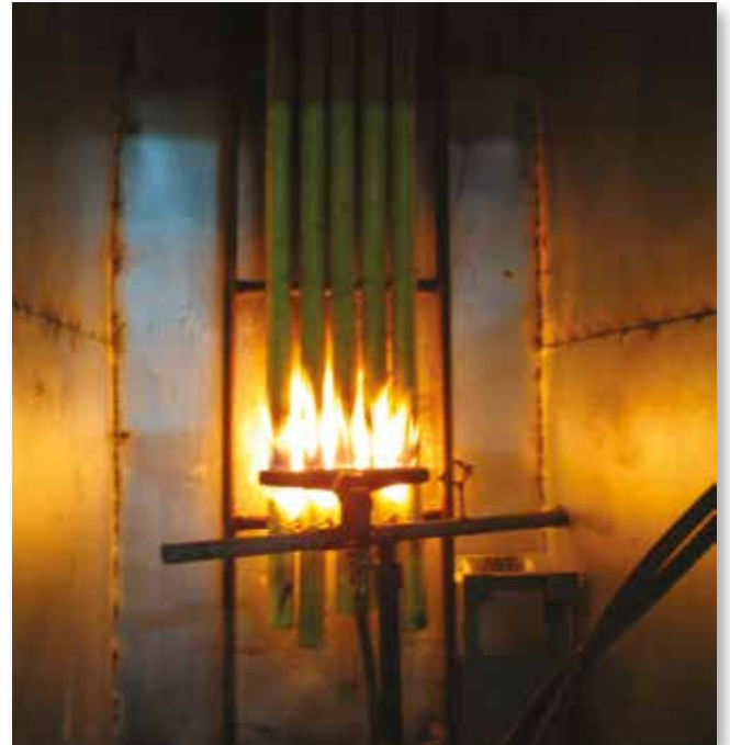
Demetlenmiş kabloların yanması testindeki bir kablo numunesi.
