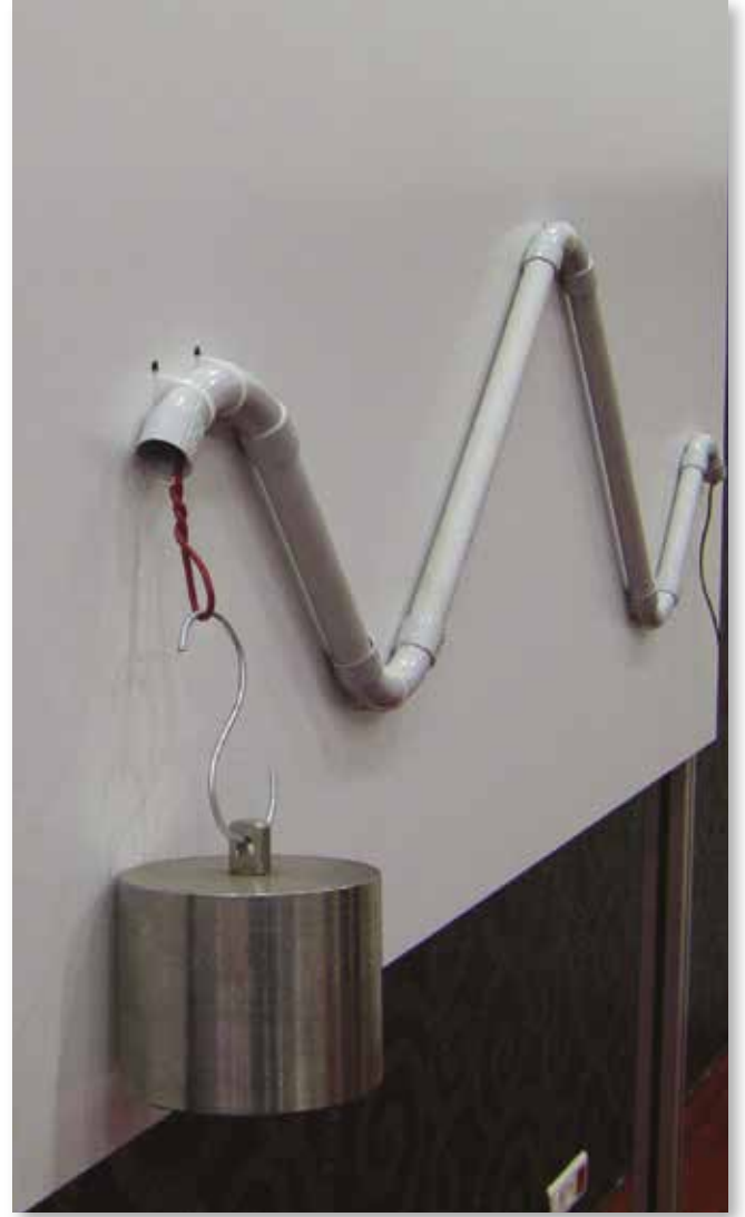
Kaygan kablolar düşük miktarlardaki kuvvetlerde bile boru içerisinde rahatlıkla hareket ederler.
