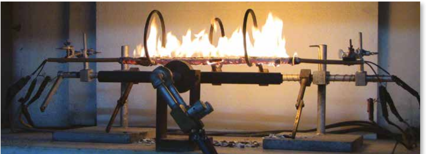
Gerilim altında yanma testindeki bir kablo numunesi.
