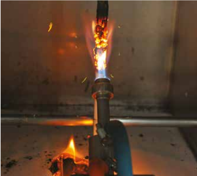
Yanan damlacık testindeki olumsuz bir kablo numunesi.
