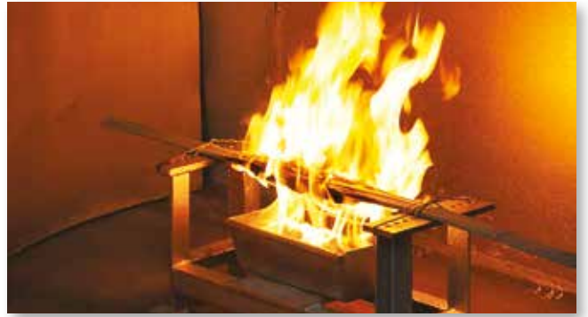
Duman yoğunluğu testinde, yakıt standartlardaki ölçülerde konulmalıdır.
