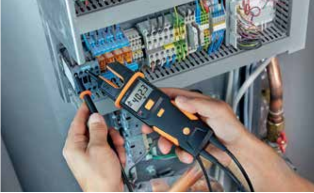
testo 755 ile bir ısı pompası üzerinde gerilim testi
