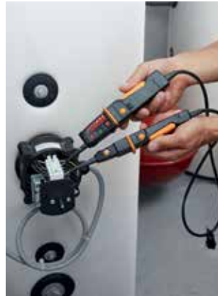
Kazanda gerilim ölçümü
