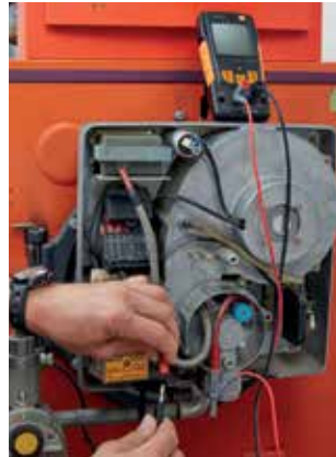
İyonizasyon akımı ölçüm kurulumu
