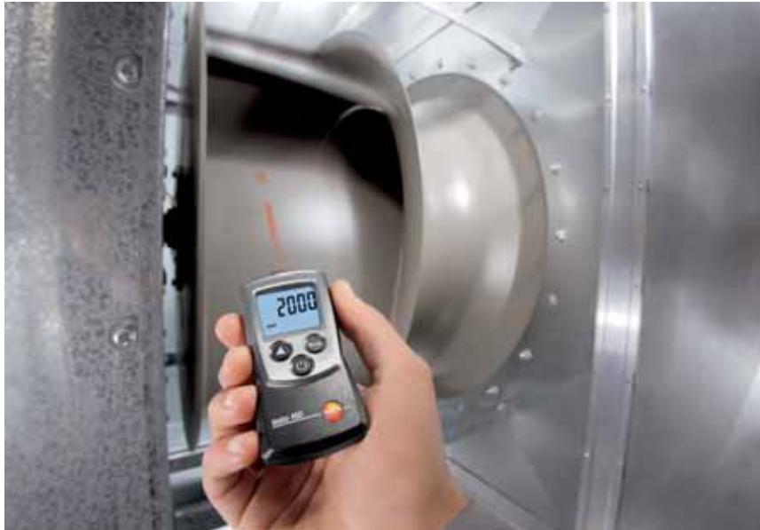
Aspiratörlerdeki temassız ölçümler, testo 460 cihazı ile yapılabilir. LED işaretleme ile, ölçüm yeri değeri görüntülenebilir.
