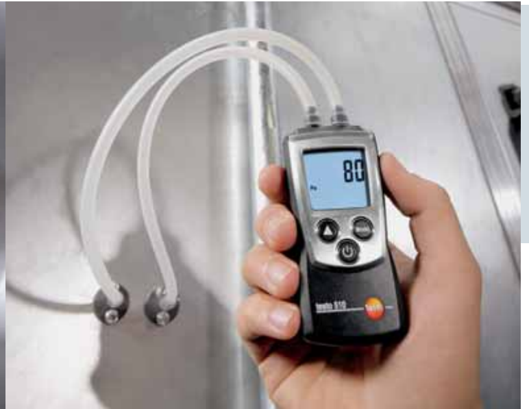
Fark basınç ölçüm cihazı ile filtrelerdeki kirliliği kontrol edebilirsiniz, örn.testo 510.
