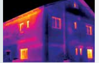
Binalardaki enerji kayıplarını görüntüleyin: Binalardakitermal köprüleri anında tespit edin ve kaydedin.
